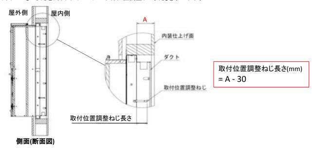
【15】プラスドライバーで4カ所の「取付位置調整ねじ」を回し、「取付位置調整ねじ長さ」を【14】で求めたに長さに調整します。 調整後、「受取扉」を開口の奥まで差し込み、「受取扉」の位置が下図と同じになっていることを確認します。
