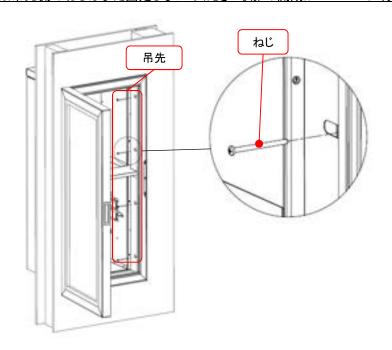
【18】「受取扉」を吊元側の「ダクト」の長穴に向かって4本のねじで固定します。 ※この作業には電動ドライバーを使わないでください、「受取扉」が歪む可能性があります。
