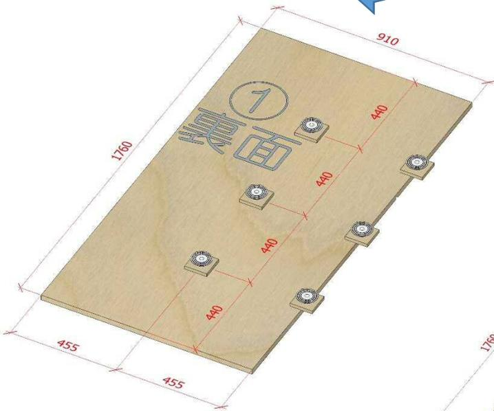
2. ①、②910×1760 の 24mm 合板の裏面に左図の位置に合わせて束柱を貼り付けます。
