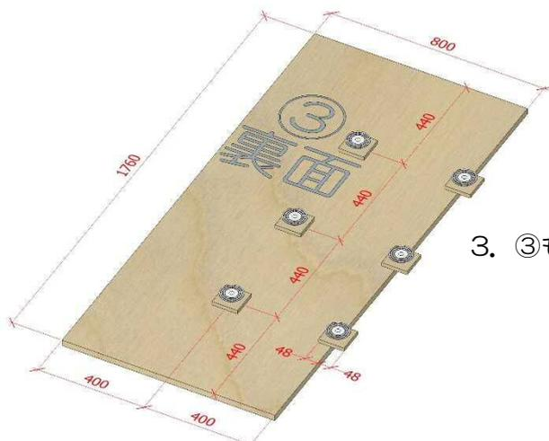
3. ③も同様に 24mm 合板の裏面に束柱を貼り付けます。
