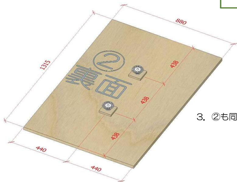
3. ②も同様に 24mm 合板の裏面に束柱を貼り付けます。
