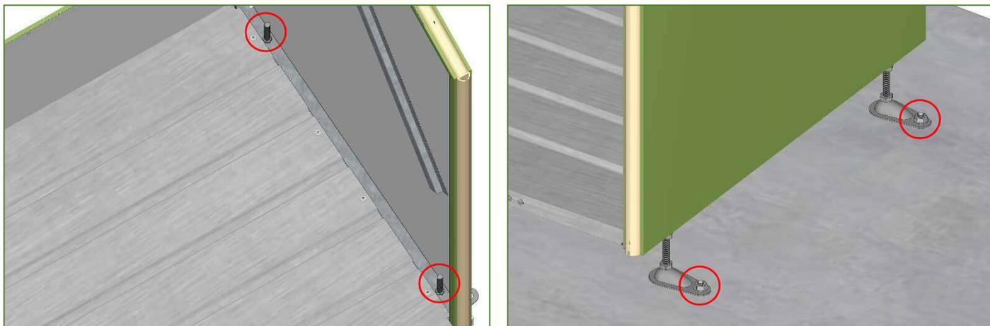
5. メタルフロア前面中間部にパッカーやレンガなどの隙間埋め材を挟み込み、メタルフロアが凹まないようにして、TM3の組立ての続きを行ってください。
