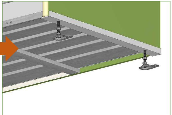
3. 水平レベルが合うようにナットで調整します。
