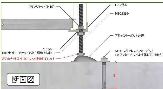
4. レベル調整を終えたら、フランジナットでアジャスターボルトに取り付け、締め付けます。
