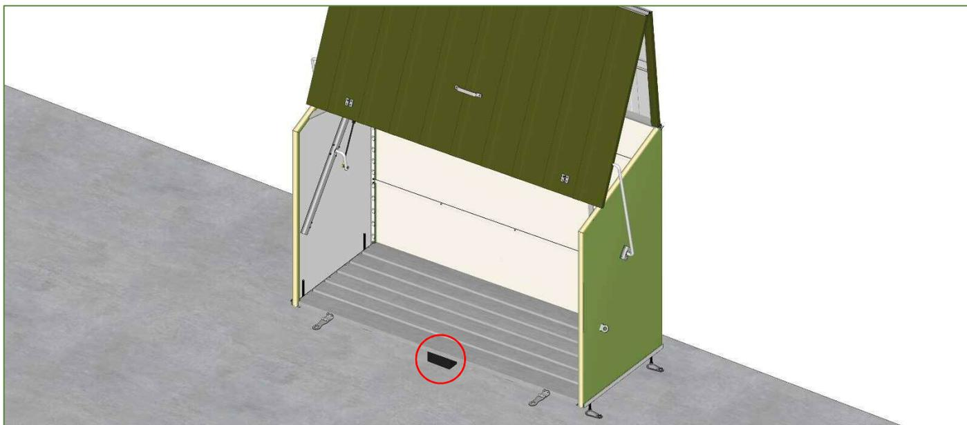
※メタルフロア前面に挟み込む隙間埋め材（市販品）は、必ず棧がある位置に取り付けてください。
