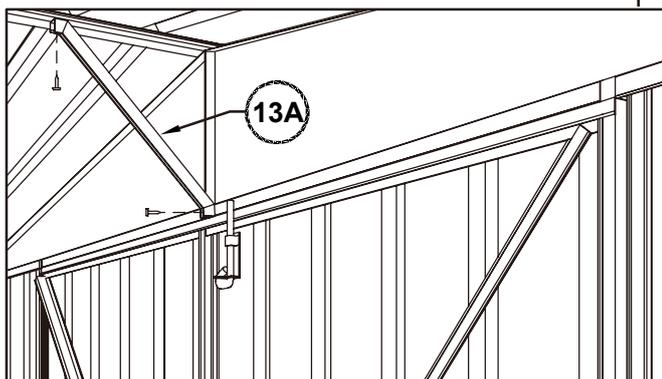
上記のように両方の屋根パネルを壁に取り付けた後、図のように1つのリージェントブレースを棟梁と前壁に取り付けます。固定位置にある既存のネジを取り外して交換する必要があります。後壁のリージェントブレースに対してこの手順を繰り返します
