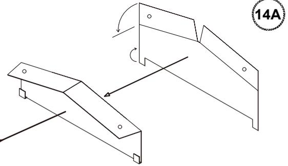
図のように上下のフランジを曲げてから、下のフランジを上部のチャンネルの下に引っ掛け、2本のネジで上部をリッジビームにネジ止めします。
