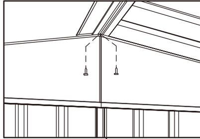
各端に2本のネジを使用して、棟梁を切妻セクションに固定します。この段階でのみ、各コーナーで1つのネジで各ルーフパネルを固定します
