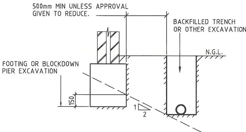
接触者は、既存のフーチングの近くで調査する前に、それらの深さを確認するために調査的な局所発掘を行うものとします。エンジニアの書面による承認なしに、上記の深さまで掘り下げることとはできません。
