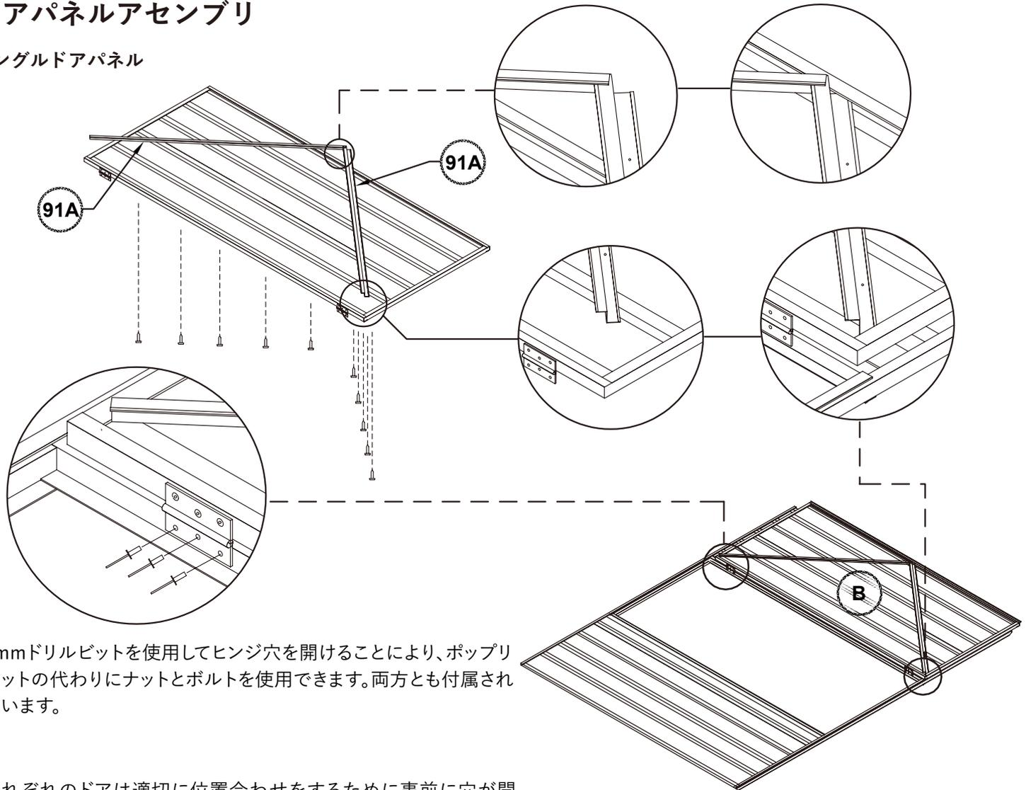
4mmドリルビットを使用してヒンジ穴を開けることにより、ポップリベットの代わりにナットとボルトを使用できます。両方とも付属されています。
