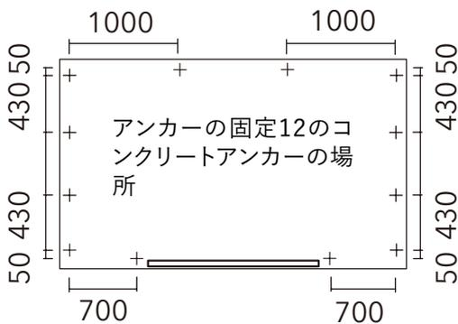
各アンカーは、1つのナット、ボルト、M10ダイナボルト、スチールアングルで構成されています。
