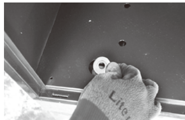
8. 付属のワッシャーを全ネジに通します。
